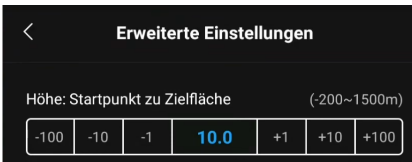
Abbildung 0-6: Unter Erweiterte Einstellungen grob die Dachhöhe eingeben
