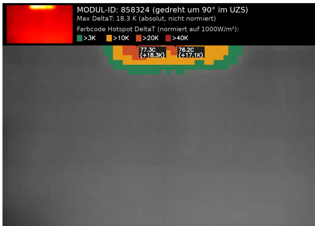
pixelgenaue Auswertung der Hotspot-Zonen am Beispiel von Modul 858324
